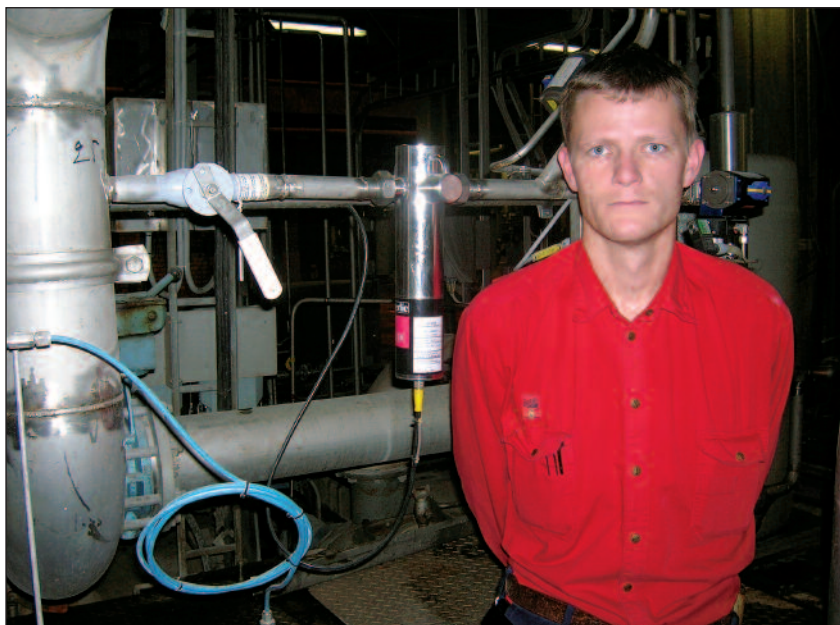
– Cerlics givare CTXP03/25 klarar noggrann mätning av sann susphalt vid låga halter och vid varierande blandning av fiber och fyllmedel. De fungerar alldeles utmärkt, säger instrumenttekniker Magnus Domeij.
