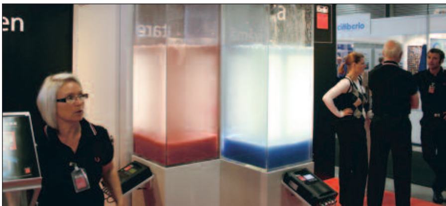
I centrum av Cerlics monter på VA-mässan 2009 fanns en installation med tre CBX slamnivåmätare. De var programmerade att gå kontinuerligt. I botten av var och en av behållarna fanns ett lager upplöst färgat papper, som bildade en massa avsedd att symbolisera slammet i ett reningsverk. Givarbuvudena var programmerade att stanna vid en viss slamhalt. Tydligt såg man hur givaren tog sig igenom det förorenade vattnet för att gå på gång stanna precis i nivå med slamnivån.
