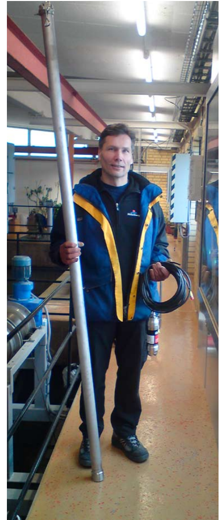
Per-Erik "Perra" Östberg med insticksröret som gör det möjligt för Cerlics ITX-givare att fungera som en inlinemonterad slamhaltsmätare.
