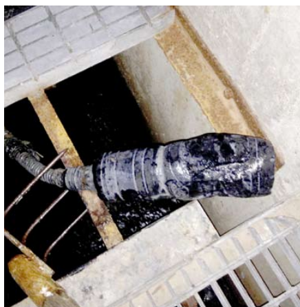
En "modifierad" PET-flaska ser till att provtagningen på det inkommande avloppsvattnet kan fortgå utan störningar.
