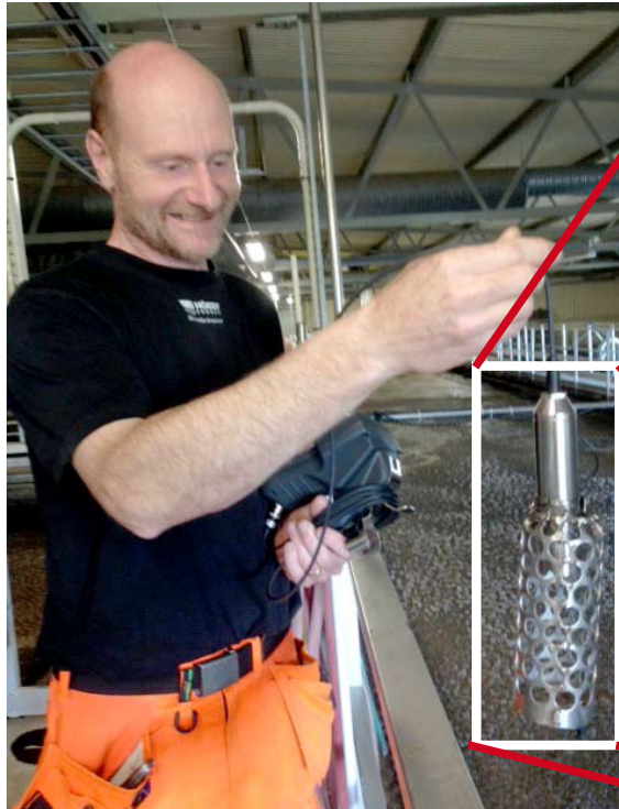
Rolf Nilsson på Lyby reningsverk visar MultiTrackern med ”skyddsgaller” innan han sänker ner den i bio-tanken för att mäta syrehalten.
