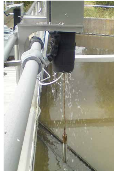
CBX 随附配有一个带 SS 滑轨安装组件的不锈钢壳体，可便捷安装至滑轨上。每个周期后线缆和传感器自动水冲洗系统。
